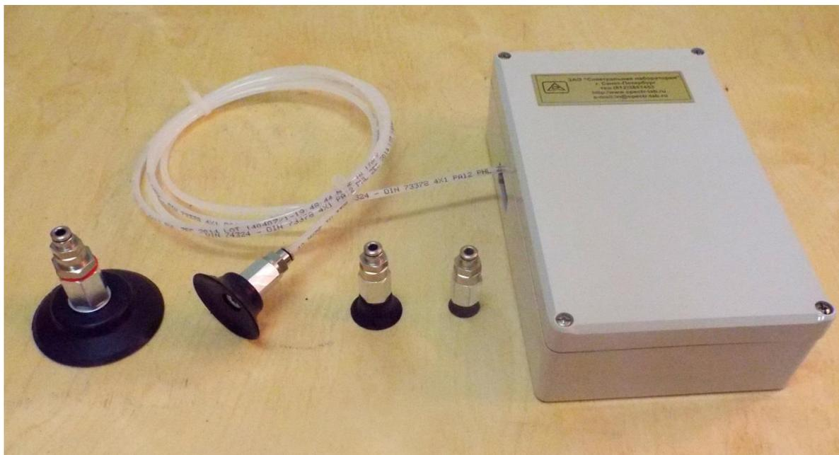
Держатель состоит из вакуумной присоски и вакуумного генератора, соединенных пневмотрубкой. Вакуумный генератор состоит из вакуумного микронасоса и сетевого блока питания. Присоска подключается к трубке с помощью быстроразъемного фитинга.
